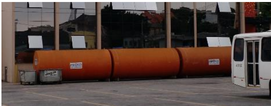
Figura 08: Tanques de armazenamento de combustíveis aguardando a instalação
